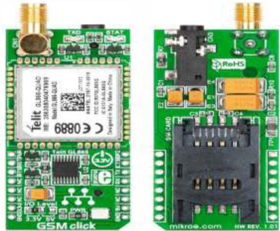
Fig. 3 GSM Module
