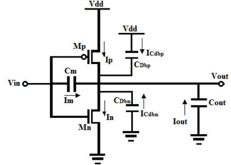
Fig. 1. The CMOS inverter
